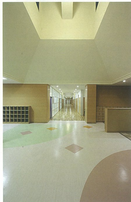
昇降口ホール。ハイサイドライトを設けて明るいホールを実現
